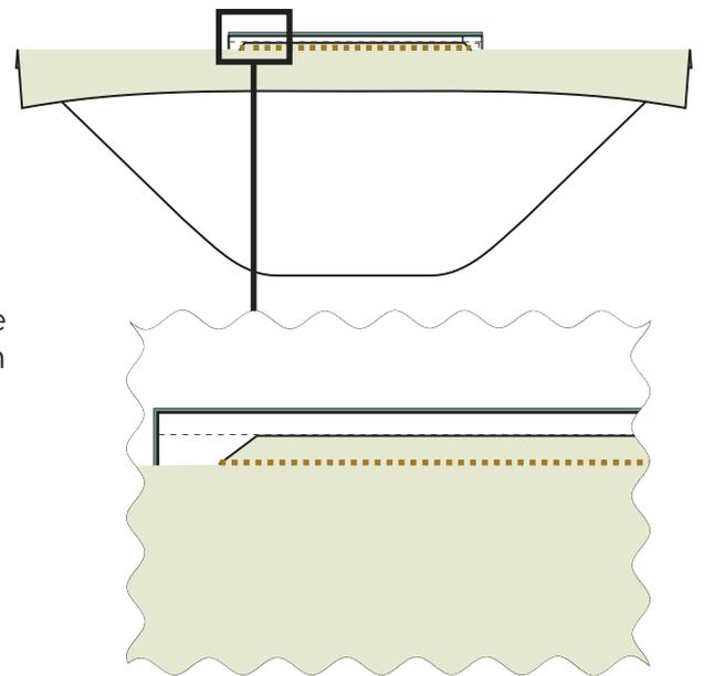
**14** Nun können die kurzen Seiten der Taschenöffnung festgenäht und die gesamte Seitennaht des Taschenbeutels in einer Naht geschlossen werden.
