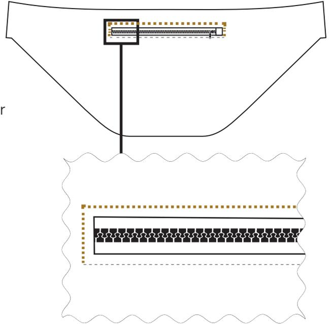
**17** Schneide den 2ten Reißverschluss zu, Mini - 34,5cm, Midi - 45,5cm, Maxi - 56,0cm, und nähe die Reißverschlussenden wie in Punkt 4 an, nachdem du die Zipper entgegengesetzt aufgefädelt hast.
