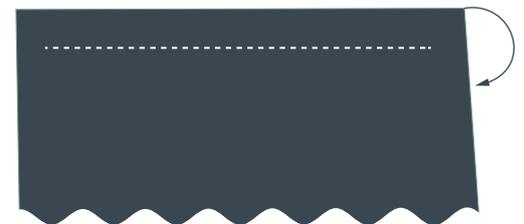
**9** Klappe die Nahtzugabe um und schneide die eingezeichnete Y-Markierung mit einer spitzen Schere sorgfältig und exakt bis zum Nahtende auf. Achte darauf, dass du die Nahtzugabe von Reißverschluss und Taschenbeutel nicht mit einschneidest.
