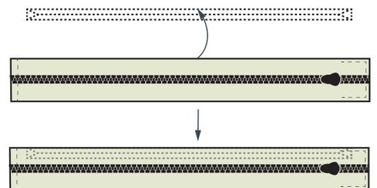
**7** Nähe den Reißverschluss mit einem schmalen RV-Füßchen an der oberen Nahtzugabe an das Rückteil an. Achte dabei darauf, dass du die 1cm Nahtzugabe an den Enden einhältst und nicht nähst.
