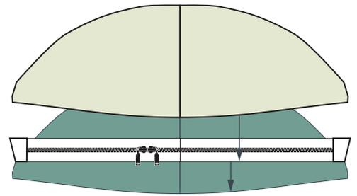
**11** Das Futter dicht an der Nahtkante auf die Nahtzugabe steppen (1-2mm). Sollte das Nähfüßchen das Futter schieben und Falten verursachen, musst du alle paar Stiche das Füßchen bei versenkter Nadel heben und den Stoff glatt streichen.
