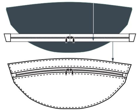
**16** Die beiden Deckelschnittteile werden an den oberen Reißverschluss genäht. Beachte dabei die Knipse, damit du die Weite in den Rundungen richtig verteilst.
