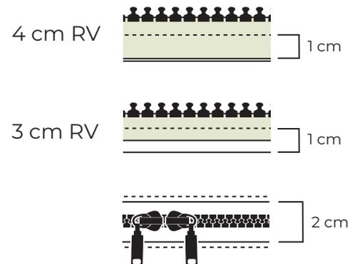
Die überschüssige Breite der RV-Enden bei einem 3 cm RV kannst du auf die Reißverschlussbreite zuschneiden.
